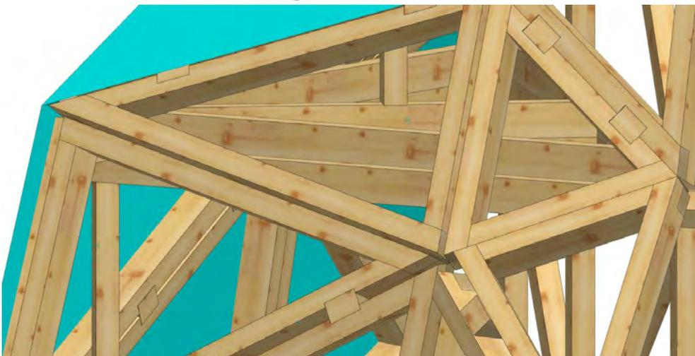
Die Konstruktion der Holz-Holz-Verbindungen wurden im cadwork gemacht. Nummerierung der Bauteile, Baugruppen und Bauuntergruppen zugeteilt.
